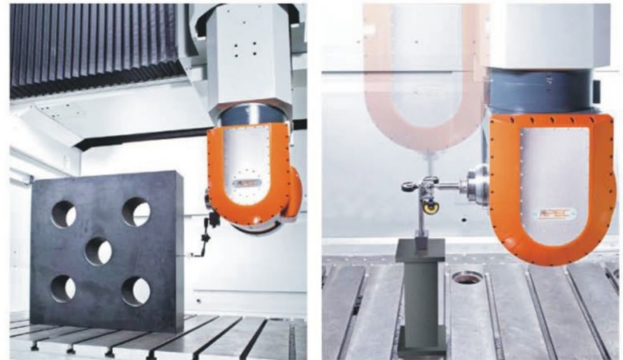
1m X 1m 花崗岩幾何精度測試確保 XY、XZ、與 YZ 之空間幾何精度
