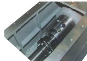
主轴箱采用最佳化比例设计当主轴箱下伸时, 悬伸量与夹持量保持小于1:1的比例, 且Z轴使用硬轨, 可吸收部份震动, 以确保铣削时的稳定性。
