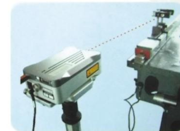
全系列机型在出厂前皆通过雷射干涉仪及球杆仪校正精度与马达效率, 符合制造标准。
