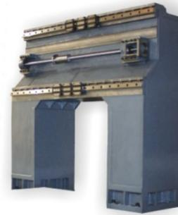
一体式门梁设计减少锁点数量并以大门柱尺寸, 强化结构强度, 得以支撑减少横梁下垂, 并加大Y轴线轨站距, 提升铣削时的稳定性。
