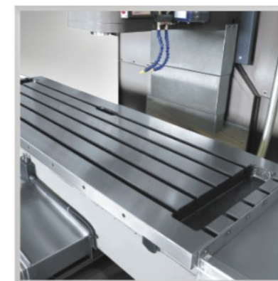
· 宽大导轨设计，淬硬精密研磨，滑动面细密铲花，精准耐用。
